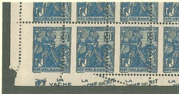
Détail de l'accident de perforation due à une pliure du papier
